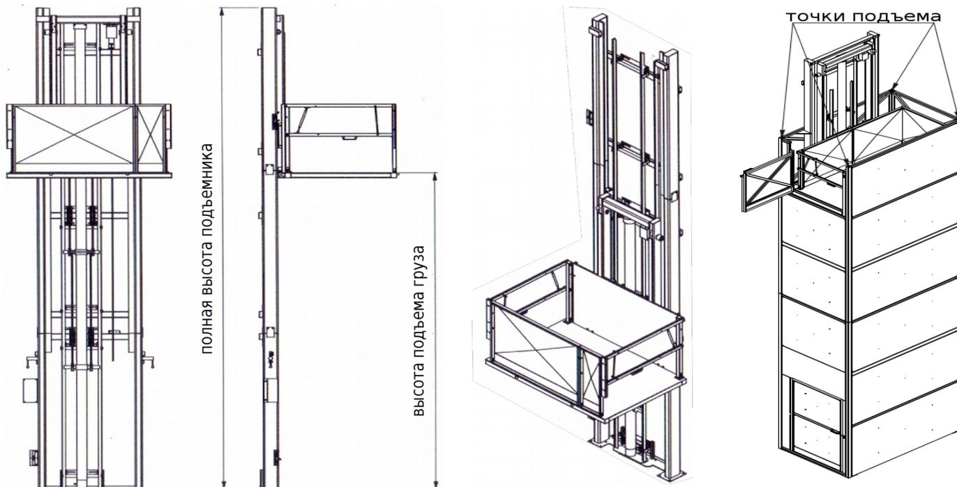
Для заказа подъемника необходимо указать следующие параметры: грузоподъемность, требуемую высоту подъема груза, высоту потолка в помещении, размер платформы, необходимость ограждения платформы.
